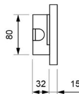
Montaje enrasado (corte: 292 x 130 mm)
